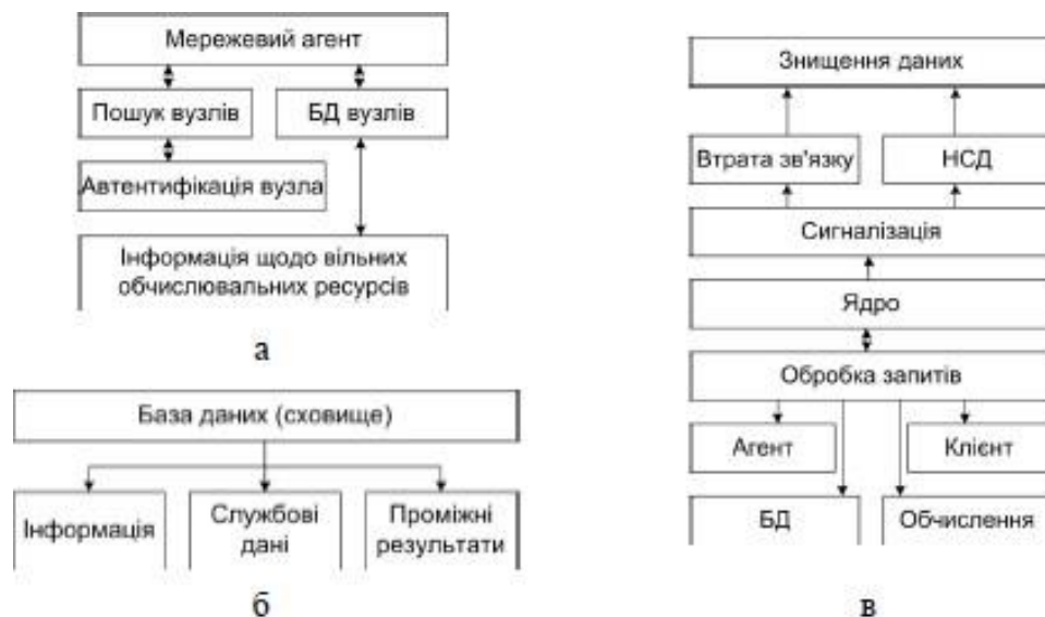
Рисунок 5.3 – Структура мережевого агента, бази даних, ядра програмного забезпечення на вузлах
